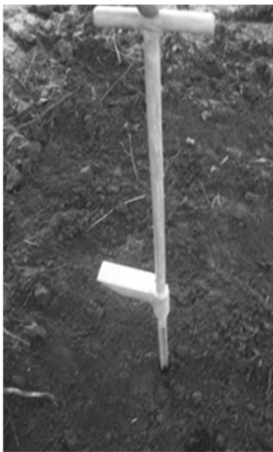
Рис. 2. Удосконалений бур для відбору зразків ґрунту
